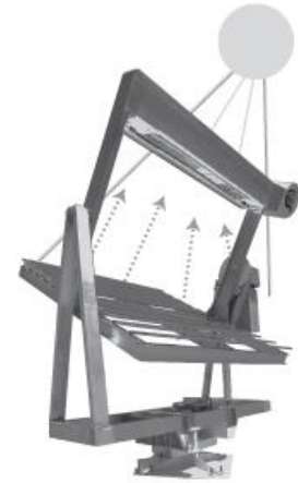
図4: ターゲットボードは鏡の真向かいにありサンプルは太陽ではなく鏡を直接見えています
