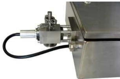
ベンチュリシステムによって測定セルへ粒子が吸い込まれます。それから、粉体試料はプロセスにフィードバックされます。
