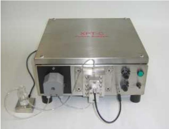
試料容器またはプロセスの分散液は、チューブポンプによってユニット前面のフローセル測定部に直接送液されます。CCD カメラで連続的に画像を撮影し、リアルタイムで分析します。
