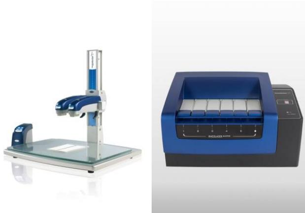
液体のレオロジー特性を測定する手法として回転式のレオメータが一般的ですがサンプルのレオロジー特性が変化する様々な状況においてそれをモニタリングすることは困難でした。RHEOLASER(レオレーザー)シリーズはそんな難しさをレーザーによる非破壊測定により解決してくれるシステムです。非常に弱いネットワークを持つポリマー溶液のレオロジー特性を評価することでゲル化の評価を行ったり、塗布した塗料のレオロジー特性を評価することで塗膜の乾燥工程を評価したりなどアプリケーションは多種多様に存在します。
