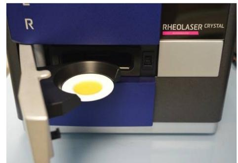
バターやマーガリンなどは使用用途に応じて使いやすいように融点が変わっています。そのため原料や処方などを色々変えています。その際に油脂の結晶化・溶解温度の正確な測定が必要となります。Rheolaser Crystalでは正確な溶解温度の測定が可能であり、明確な差が見られました。
