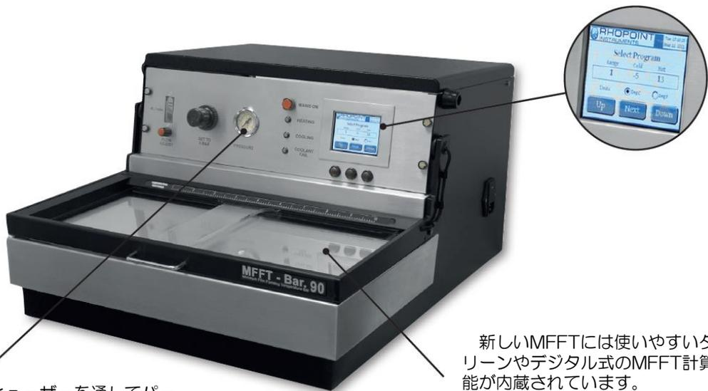
乾燥空気をディヒューザーを通してパージし、ステージ上に流します。開閉式の上部カバーは熱と外気を遮断する役割があり、目視で行う本評価を均一なものにする役割があります。造膜点までカーソルバーを移動させると自動で造膜温度を計算します。
