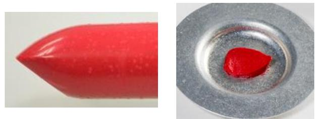
リップスティックはワックスが主原料で色素、ポリマー、界面活性剤などが添加されて作られます。リップスティックを長期で保管するとワックスの結晶構造が変化し、表面に滲出して再結晶することがあります。
