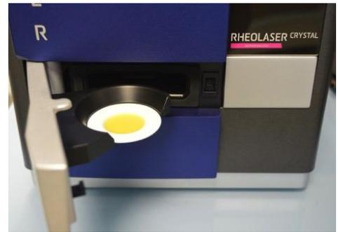
バターやマーガリンなどは使用用途に応じて使いやすいように融点を変えてあります。そのため原料や処方などを色々変えていますが、その際に油脂の結晶化・溶解温度の正確な測定が必要となります。Rheolaser Crystalでは正確な溶解温度の測定が可能であり、明確な差が見られました。
