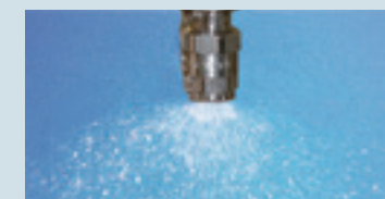
屋外における水分の劣化をシミュレーションする純水スプレー
