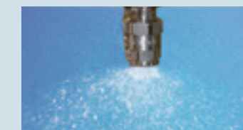
屋外における水分の劣化をシミュレーションする純水スプレー
