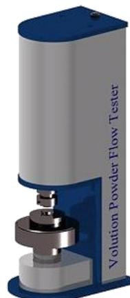
圧密荷重・せん断力により流動性を高精度に評価
