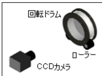
回転ドラム内にある粉体の挙動を内蔵 CCD カメラで連続的に撮影します。実際に粉体が存在する黒色部分を様々な形で数値化して、その流動性を求めます。
