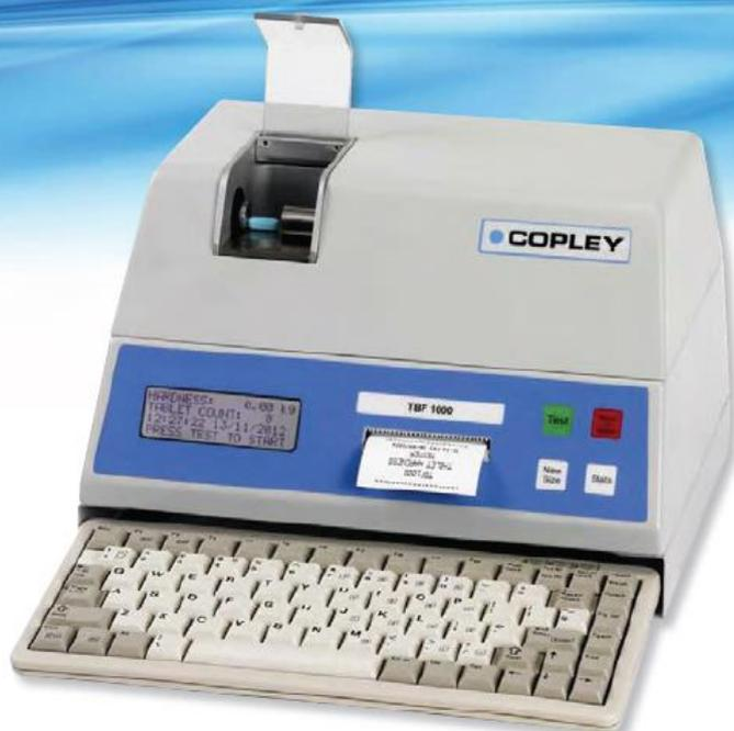
一般に、速度または荷重がより低いほど、より首尾一貫した結果が得られます。米国薬局方は、たとえば、3 mm / 秒未満の一定の圧盤移動速度を提唱しています。
