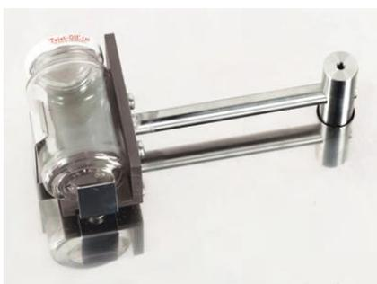
サンプル容器内におよそ10g (m1)の製品を秤量して、ツイストキャップをしっかりと閉めてください。Friabimatにしっかりと固定されているスプリングクリップに、サンプル容器をしっかりとはめてください。安全カバーを閉じてください。
