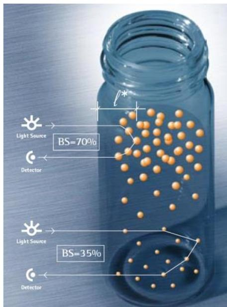
液中に存在する分散体の評価方法には様々なものがありますが、分散安定性評価において最も多くの情報を与えてくれる方法が光照射時の透過光、後方散乱光のマルチ散乱光測定です。これは分散体を含む液体をサンプリングしたボトルに外部から近赤外光を照射し、透過光強度、後方散乱光強度を一定時間ごと、高さ方向に測定することで分散体の濃度勾配の経時変化、分散体の変化を評価することを可能にしています。
