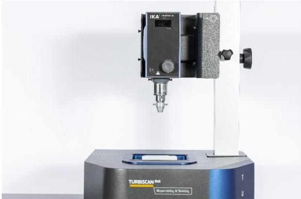
T-MIXはTURBISCAN DNSにおける攪拌機能を使った評価方法です。測定ボトル内を直接的に攪拌することが可能で、攪拌時間 vs 平均粒径の評価を行うことができます。分散溶媒の選定や適切な分散剤の選定、最適濃度の決定等を簡易的に行うことができます。
