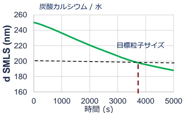
例：目標粒径までの破碎時間評価
