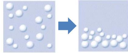
分散体の沈降のイメージ
