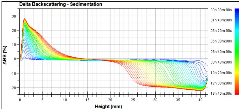
分散体の沈降の事例
