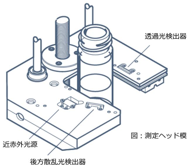
図：測定ヘッド模式図
