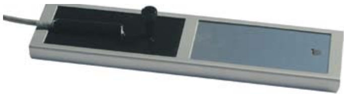
ブラックパネル温度計は、2x4インチ試料ホルダーに固定されます。
