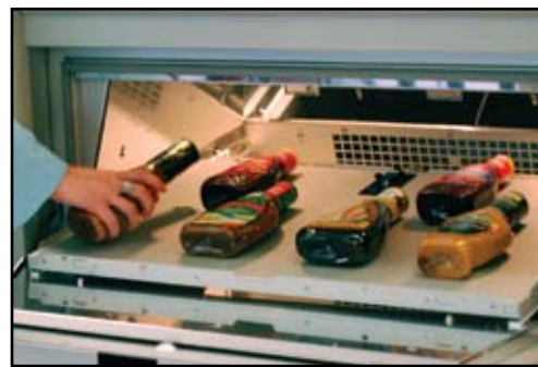
立体サンプルも直接フラット・サンプルトレイに設置する事ができ、多くの場合でサンプルホルダーを必要としません。
