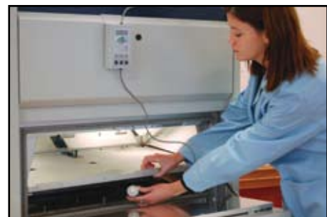
CR20照度校正器のUV照度センサーを、サンプルトレイのポートに装着します。
