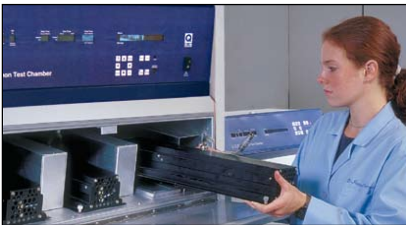
Q-Sun空冷ランプは試験機前面から簡単に取外し出来ます。
