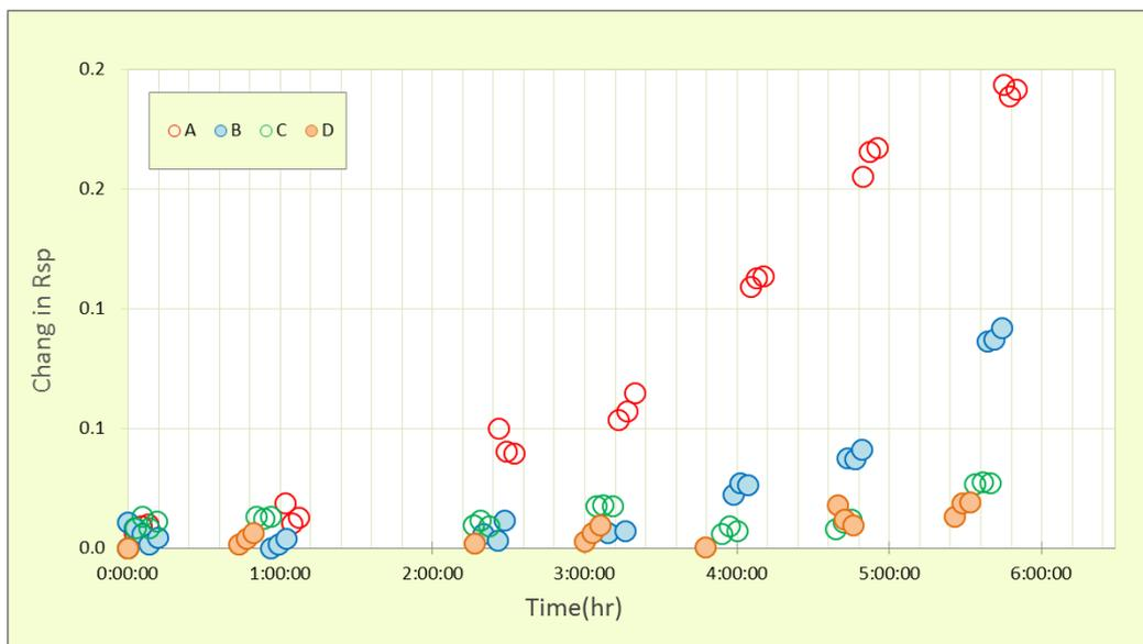
吸水特性のある有機化合物水分散液の緩和時間を連続して測定したデータです。
