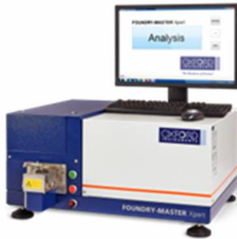
図 19 最新の据置型分光分析装置（OXFORD INSTRUMENTS 社製品 FUNDY MASTER Xpert）
