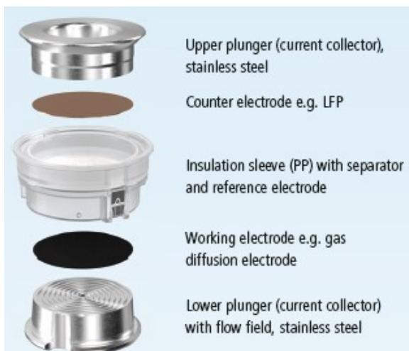
フローフィールド付きの下部プランジャーを使用したPAT-Coreセットアップは定量的な時間分解分析に不可欠なバージガスのほぼ完全なプラグフローを提供します。作用電極で放出または消費されるガスは通過するガス流れの組成を変え、作用電極の下のスパイラルタイプの流れ場に沿って流れます。
