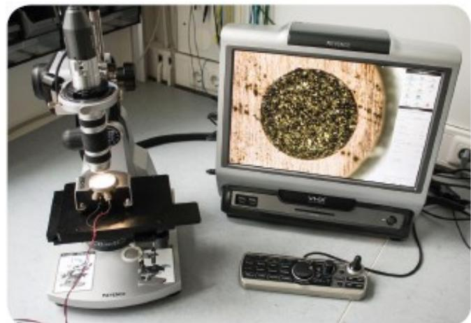
この実験では、ECC-Opto-Std 試験セルを用いて、電気化学的リチウム化中の黒鉛電極の色変化を可視化しました。顕微鏡は、黒鉛電極の裏側に配置された銅箔の直径 1mm の穴を通して観測しました。
