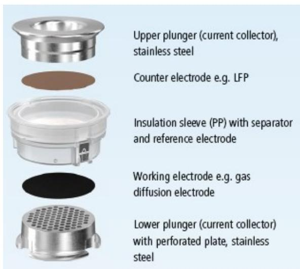
穴あきプレート付きの下部プランジャーは、Li-Air電池に使用されるガス拡散電極の電気化学的特性評価を可能にします。下部電極は穴のあいたステンレス鋼の集電体に支えられ、また、それを介して「呼吸」を行います。
