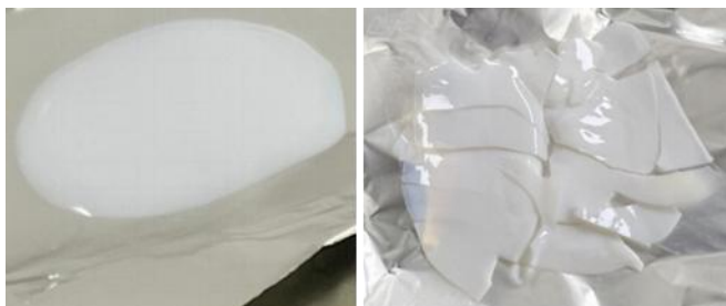
↑図 1. 70℃で 3 時間乾燥する前(左)と後(右)のシリカスラリー
